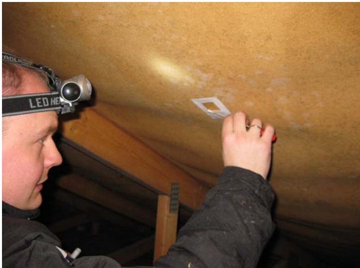
Udtagning af mycometer-test på undertaget med skimmelvækst
